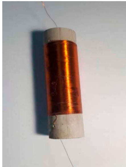
Рис. Намотка вторичной катушки
