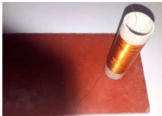
Рис. Катушка приклеенная к основе
