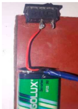
Рис. Припаивание коннектора к выключателю
