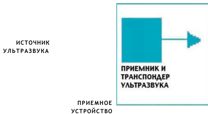
Рис. 1. Схема передачи электроэнергии с помощью ультразвука
